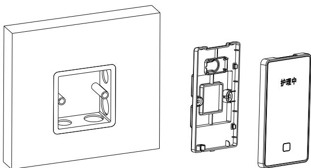
1.用两个螺丝将后盖打在墙上的86盒上
